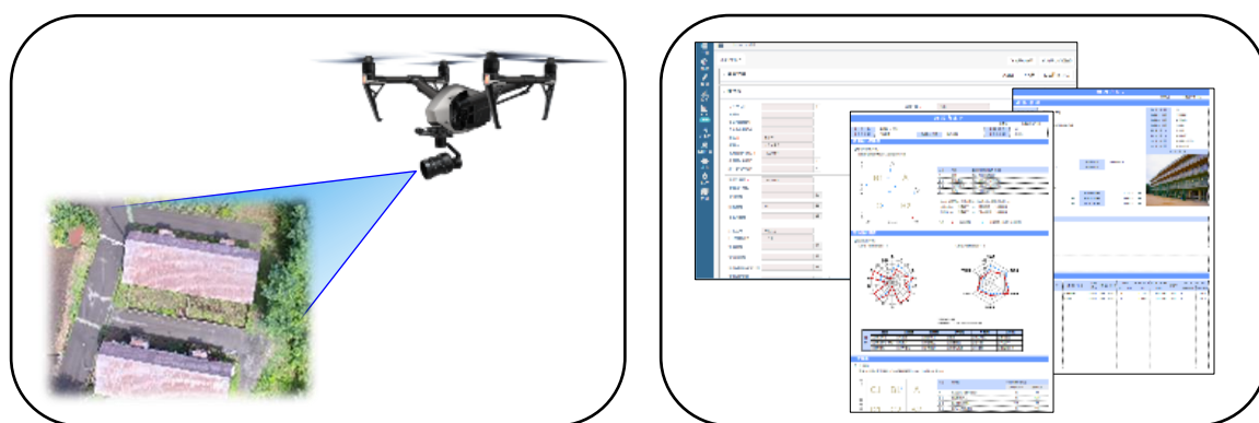
図 8.1 UAV による屋根・屋上劣化調査とデータベース管理イメージ
