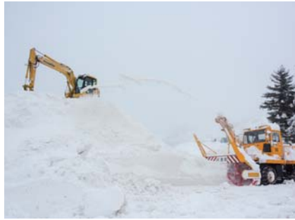
▲ロータリーやバックホーなどの重機を巧みに操り大きな雪山をつくる現場
