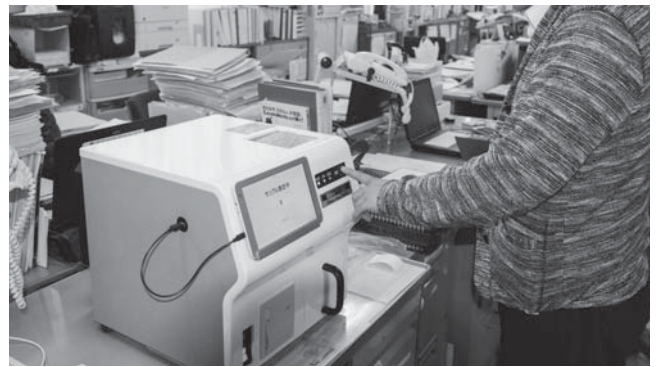
▲機械に乾燥玄米500gを入れ、約20秒後には結果が分かる「食味分析計」
