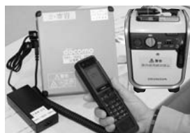
▲配備された衛星電話と発電機(右)
