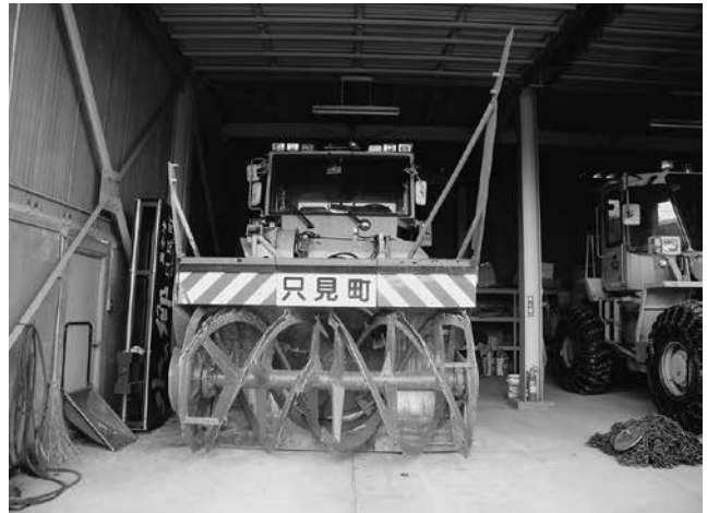
町所有のロータリー除雪車（整備前）
